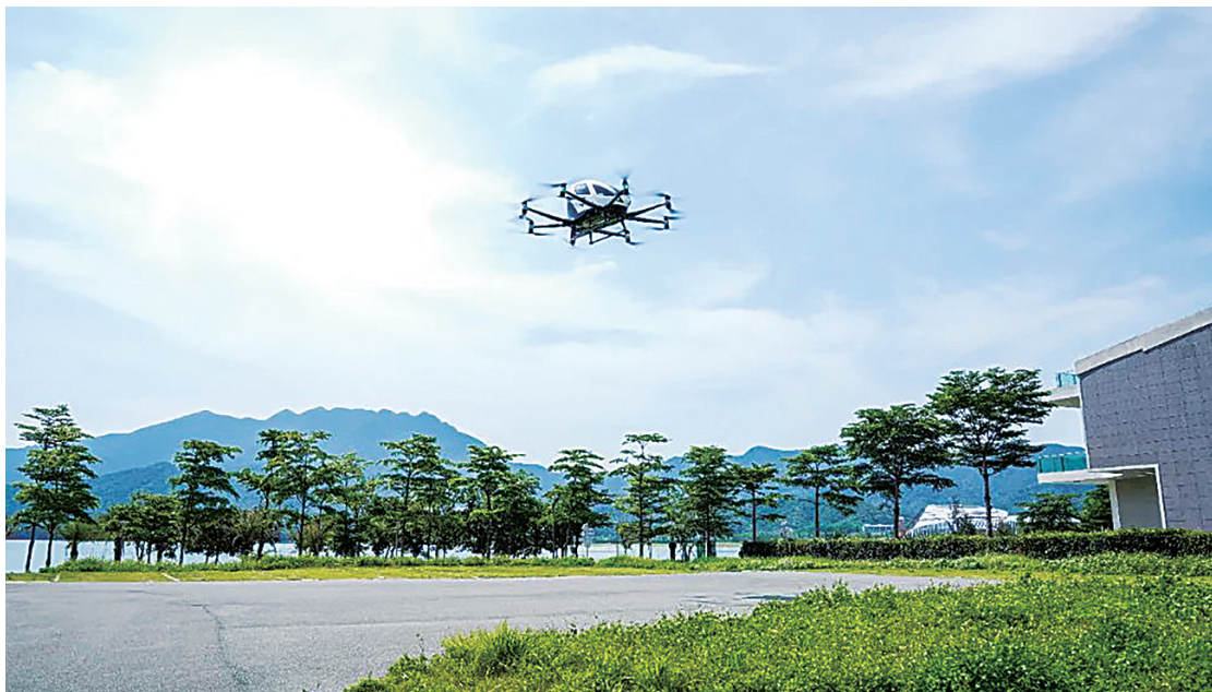
EH216-S型无人驾驶载人飞行器首飞测试。大鹏新区供图
