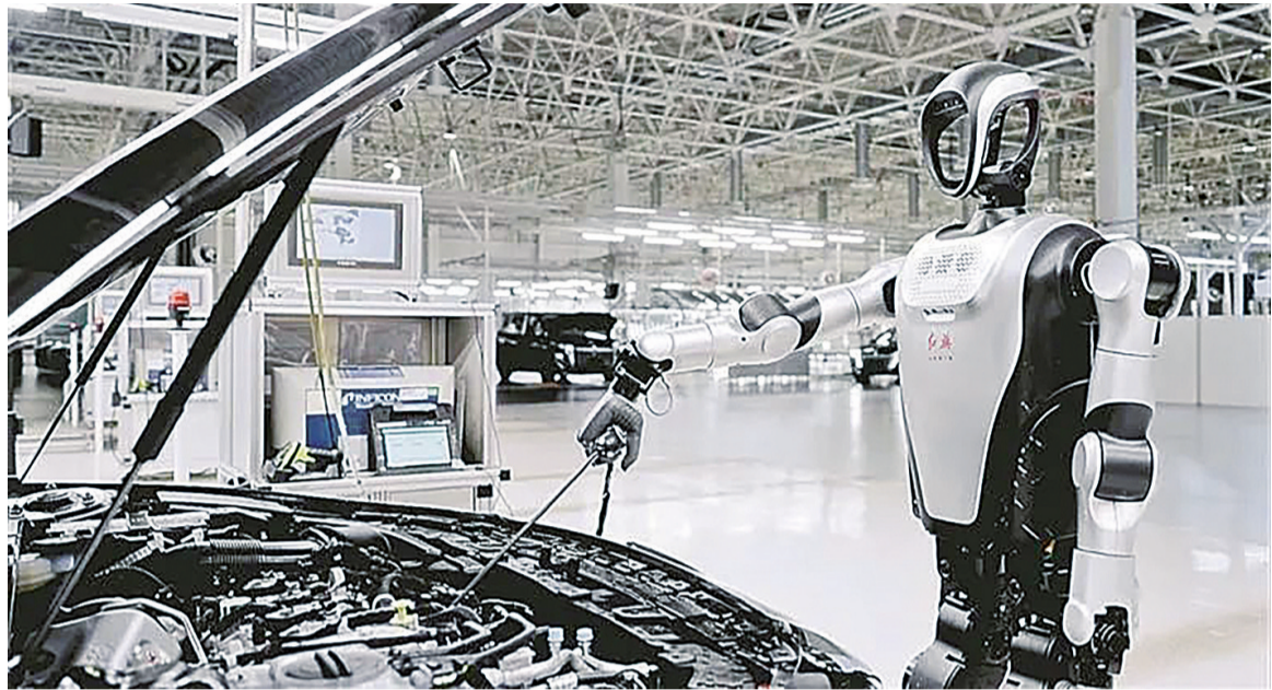
“夸父”机器人在工厂执行车辆空调检漏任务。
